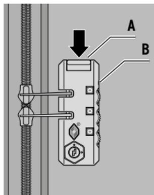
1. Stellen Sie die vorgegebene Kombination ein. Zur Kontrolle prüfen Sie, ob sich der Öffner **A** in Pfeilrichtung drücken lässt. Lassen Sie für die Einstellung die Reißverschlusszieher außerhalb des Schlosses.
