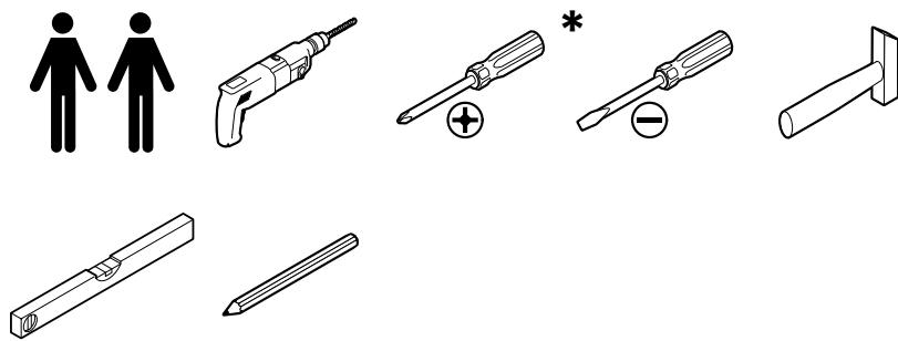
\* **VORSICHT:** Bei Verwendung eines Akkuschraubers (nicht empfohlen) möglichst niedrige Drehmomentstufe wählen!
