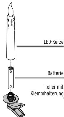
1. Drehen Sie den Teller im Uhrzeigersinn - in Richtung Open - von der Kerze ab.
