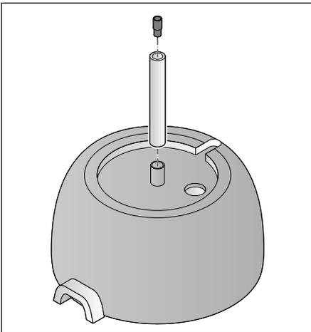
3. Stecken Sie den Schlauch unten auf den Aufsatz: Schieben Sie ihn komplett über den Aufnahmestutzen. Ziehen Sie das Verbindungsstück von der Pumpe ab und stecken Sie es unten in den Schlauch.
