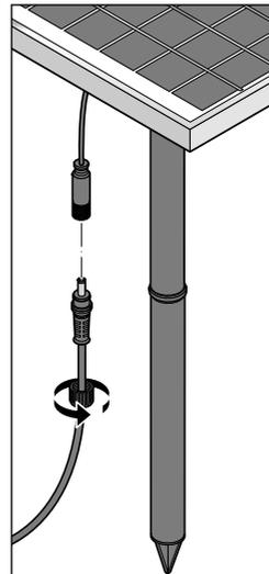
3. Stecken Sie den Stecker des Verbindungskabels in die Buchse und drehen Sie die Überwurfmutter fest.
