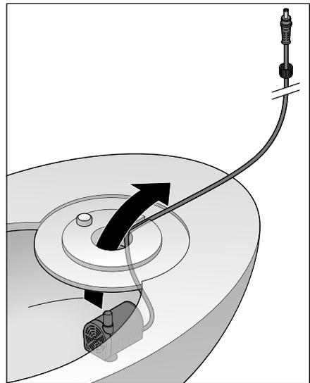
4. Stellen Sie die Pumpe unter die Stellfläche für den Aufsatz in die Schale und führen Sie zunächst das Kabel von unten durch das Loch. Platzieren Sie das Kabel in der Aussparung.
