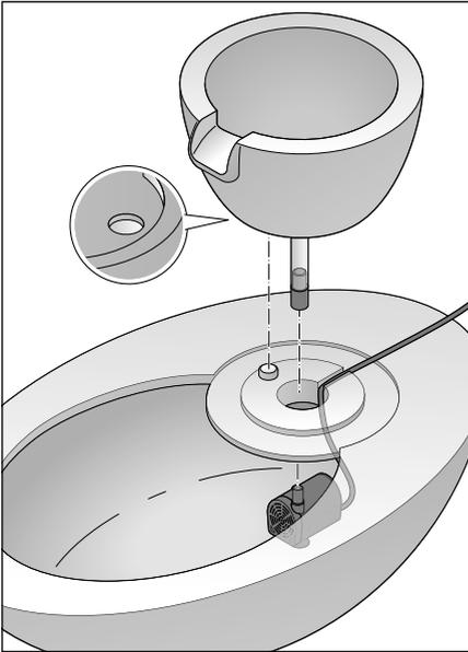
5. Setzen Sie den Aufsatz auf die Stellfläche, führen Sie dabei den Schlauch durch das Loch. Die Aussparung „Position“ unten am Aufsatz muss auf der Aufnahme „Position“ auf der Stellfläche stecken. Achten Sie darauf, dass Kabel nicht einzuklemmen! Stecken Sie den Schlauch mit Verbindungsstück auf die Pumpe.
