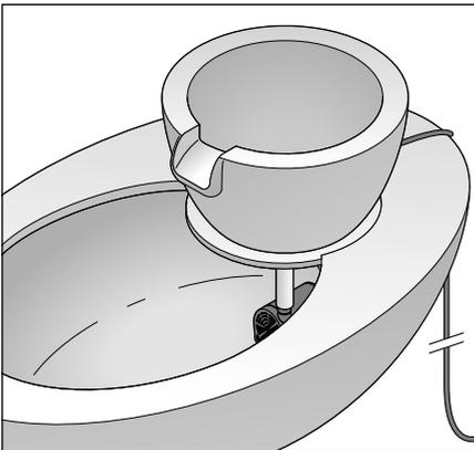
6. Drücken Sie die Pumpe auf dem Boden der Schale an, sodass sie mit den Saugnapfen haften bleibt. Achten Sie darauf, dass der Schlauch nicht geknickt ist.
