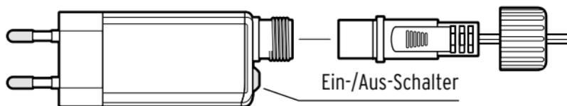
1. Stecken Sie den Stecker des Anschlusskabels in die Buchse am Netzadapter und drehen Sie die Schutzkappe fest auf.
