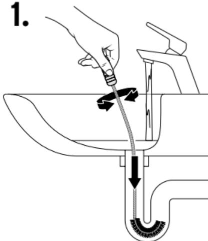
Introduisez la brosse dans le tuyau d'évacuation et faites-la tourner à droite et à gauche, ...
