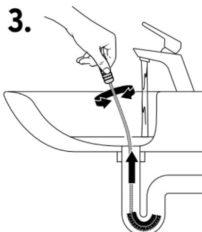
... puis, retirez-la lentement en la faisant également tourner à droite et à gauche.
