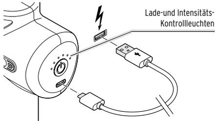
1. Stecken Sie den Stecker des mitgelieferten USB-C-Ladekabels in die Ladebuchse am Gerät.
