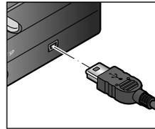
1. Stecken Sie den Micro-USB-Stecker in die Buchse USB am Piano und den USB-Stecker in das MIDI-Interface bzw. in ein MIDI-Hub.
