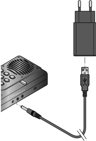
1. Verbinden Sie mit dem USB-Netzkabel den USB-Netzadapter und die Buchse **DC 5V** am Gerät.
