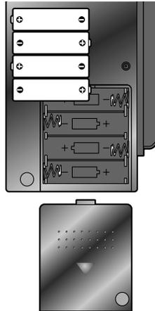
1. Schieben Sie den Batteriefachdeckel in Pfeilrichtung ab.
