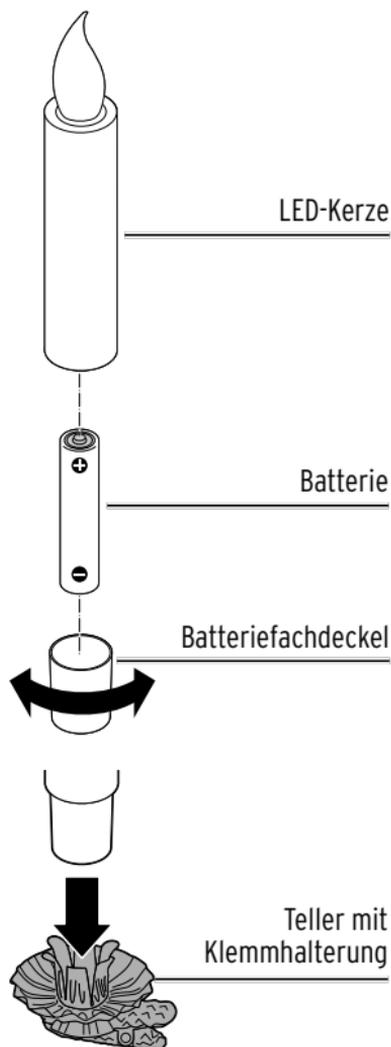
1. Drehen Sie den Batteriefachdeckel gegen den Uhrzeigersinn von der Kerze ab.
