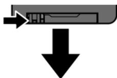
1. Drücken Sie die Arretierung in Pfeilrichtung und ziehen Sie die Batteriehalterung heraus.
