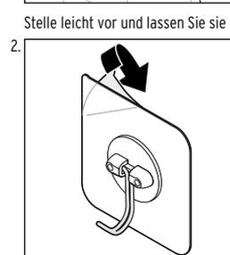
Ziehen Sie die Schutzfolie auf der Rückseite des Hakens ab und kleben Sie den Haken auf den gesäuberten Untergrund auf.
