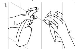
Der Untergrund muss staub-, fett-, silikon- und kalkfrei sein. Reinigen und entfetten Sie den Untergrund mit **reinem Alkohol (Isopropanol) oder Brennspiritus**. Bad- oder Allzweckreiniger sind nicht geeignet. Trocknen Sie die gereinigte Stelle leicht vor und lassen Sie sie dann gut trocknen.
