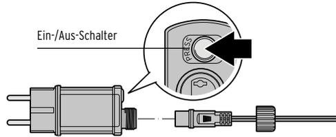
1. Stecken Sie den Stecker des Anschlusskabels in die Buchse am Netzadapter und drehen Sie die Schutzkappe fest auf.
