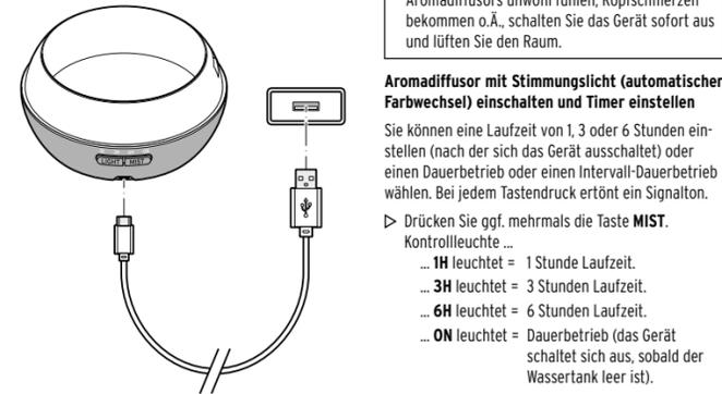
1. Verbinden Sie das USB-C-Ladekabel mit dem Gerät und dem beiliegenden USB-Netzadapter.
