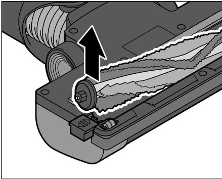
3. Heben Sie die Bürstenwalze an der einen Seite an und ziehen Sie sie aus der Halterung heraus.
