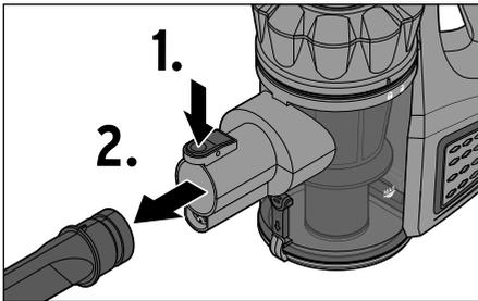
1. Drücken Sie auf die Entriegelung für das Saugrohr bzw. die Düsen (1.), und ziehen Sie das Saugrohr oder die jeweilige Düse vom Motorblock ab (2.).
