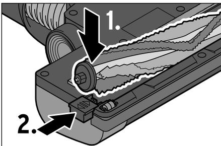
6. Setzen Sie die Bürste wieder in die Aufnahme der Bürstenwalze ein (1.) und drücken Sie die Entriegelung wieder bis zum Anschlag hinein (2.).
