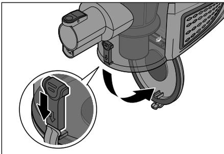
2. Halten Sie den Auffangbehälter über einen Mülleimer und drücken die Entriegelung des Auffangbehälter-Deckels bis zum Anschlag nach unten. Der Deckel öffnet sich und der aufgesaugte Staub fällt heraus.
