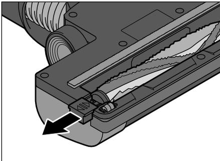
1. Nehmen Sie die Bodendüse vom Saugrohr bzw. Motorblock ab und legen Sie sie wie abgebildet hin.
