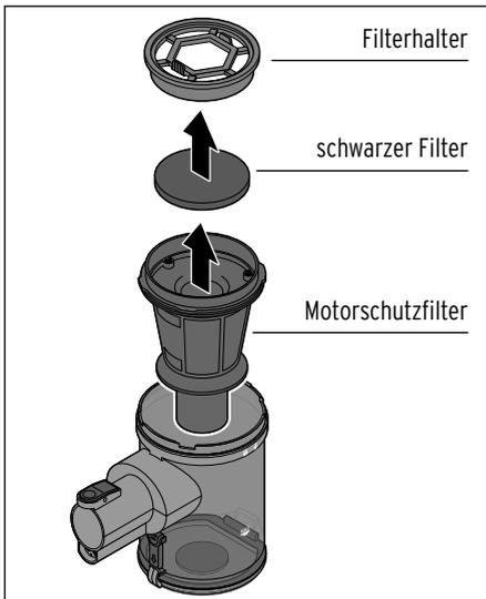
3. Nehmen Sie den Filterhalter, den schwarzen Filter und den Motorschutzfilter heraus.
