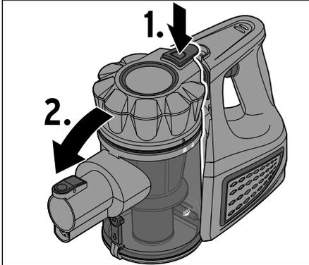
1. Drücken Sie auf die Entriegelung des Auffangbehälters (1.) und nehmen Sie den Auffangbehälter vom Motorblock ab (2.).
