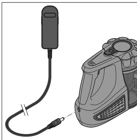
1. Stecken Sie den Stecker des Netzadapters in die Anschlussbuchse hinten am Motorblock.
