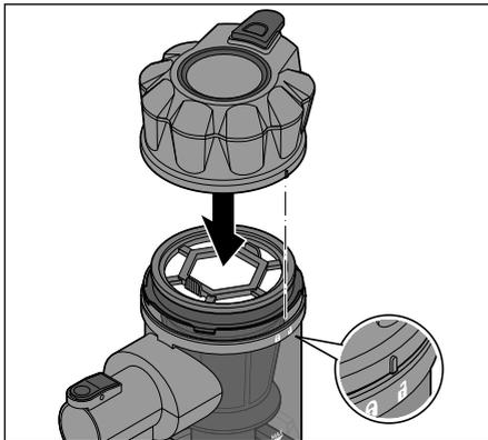
8. Setzen Sie die Auffangbehälter-Abdeckung auf den Auffangbehälter. Die Markierung an der Abdeckung muss dabei auf das
