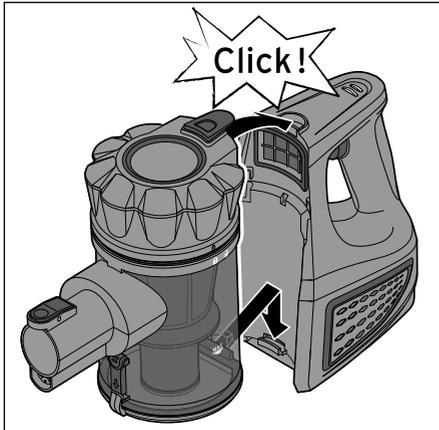
10. Haken Sie den Auffangbehälter erst wie abgebildet unten am Motorblock ein und drücken Sie ihn dann oben in Richtung Motorblock, bis er hörbar und spürbar einrastet.
