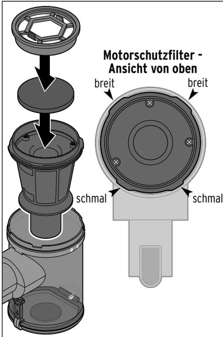
5. Setzen Sie zuerst den Motorschutzfilter ein. Der Motorschutzfilter lässt sich nur in einer Position korrekt einsetzen: Die schmalen Aussparungen müssen nach vorne zum Saugrohr und die breiten Aussparungen nach hinten zeigen (siehe Abbildung).
