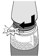
2. Setzen Sie das Gehäuse auf den Mahlgutbehälter und drehen Sie es im Uhrzeigersinn fest. Es muss hör- und spürbar einrasten.
