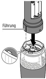
1. Setzen Sie die Motoreinheit mit dem Batteriefach wieder auf den Mahlgutbehälter. Die Führung an der Motoreinheit muss dabei genau auf die Rastnase an der Innenseite des Mahlgutbehälters passen.
