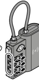
4. Schieben Sie den Einstellknopf wieder ganz nach links. Prüfen Sie die Funktion: Der Drahtbügel muss sich jetzt in das Schloss hineindrücken bzw. herausziehen lassen.
