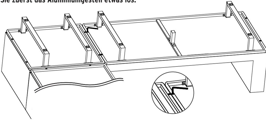
2. Wickeln Sie die Klettverbinder um das Aluminiumgestänge.
