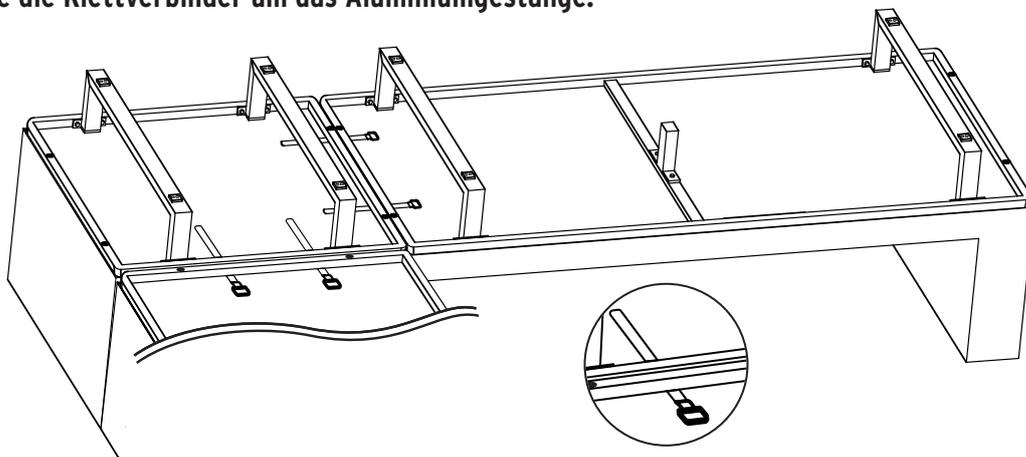
3. Ziehen Sie die Klettverbinder fest. Drehen Sie anschließend die Schrauben am Aluminiumgestell wieder bis zum Anschlag fest.
