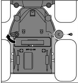
Drehen Sie den Verschluss zur Seite und drehen die Schraube mit einem Schraubendreher heraus.
