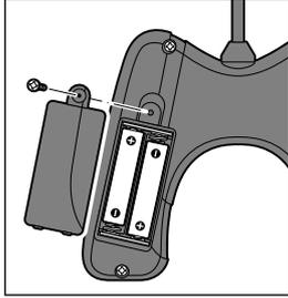
Lösen Sie die Schraube am Batteriefachdeckel und heben Sie den Batteriefachdeckel ab.
