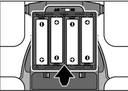
Legen Sie die Batterien, wie in der Batteriehalterung abgebildet ein. Achten Sie auf die korrekte Polarität (+/-).
