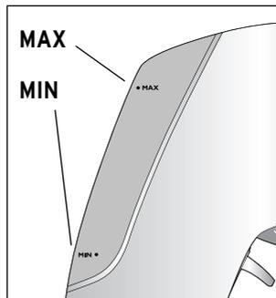
3. Heben Sie den Wasserbehälter gerade nach oben heraus. Füllen Sie den Behälter mit kaltem Wasser bis zur MAXimal-Markierung.
