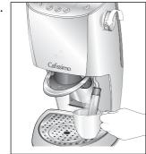
Halten Sie ein hitzeunempfindliches Gefäß mit Henkel unter die Aufschäumdüse. Drehen Sie den Drehknopf langsam gegen den Uhrzeigersinn über den Widerstand hinaus. Eine geringe Menge Wasser tritt aus.
