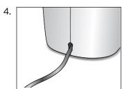
Stecken Sie den Netzstecker in die Steckdose. Die Maschine ist mit einem Kabelfach ausgestattet. Ziehen Sie die Anschlussleitung soweit wie nötig aus dem Fach heraus bzw. schieben Sie die nicht benötigte Länge ins Fach zurück. Drücken Sie die Leitung an der Austrittsöffnung nach unten, um sie zu fixieren.
