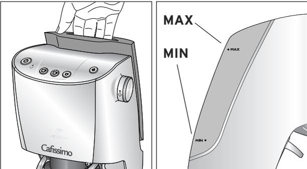
Ziehen Sie den Wasserbehälter gerade nach oben heraus. Füllen Sie den Behälter mit kaltem Wasser bis zur MAXimal-Markierung.
