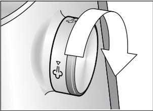
Prüfen Sie, ob das Dampfventil geschlossen ist: Drehen Sie den Drehknopf bis zum Anschlag im Uhrzeigersinn.
