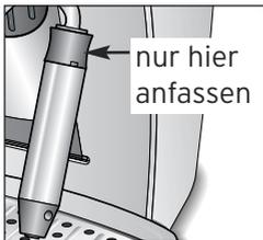
Fassen Sie die Aufschäumdüse nur am oberen schwarzen Rand an. Die Metallteile werden heiß!
