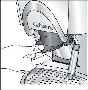
Drücken Sie den Arretierhebel nach oben. Der Kapselhalter wird entriegelt und leicht abgesenkt. Ziehen Sie nun den Kapselhalter nach vorne aus der Maschine. Halten Sie ggf. einen Teller darunter, um evtl. Tropfen aufzufangen.
