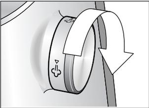
Prüfen Sie, ob das Dampfventil geschlossen ist: Drehen Sie den Drehknopf bis zum Anschlag im Uhrzeigersinn.
