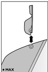
Zum Abnehmen und Aufsetzen muss der Deckel senkrecht nach oben stehen wie abgebildet. Nur so lässt sich der Deckel abnehmen oder aufsetzen.
