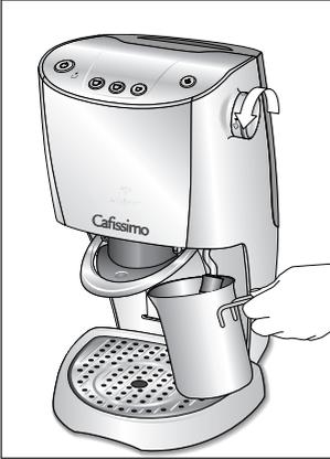
*Tip:* Um Spritzer zu vermeiden, füllen Sie zuvor etwas Wasser in das Gefäß und tauchen die Aufschäumdüse hinein.
