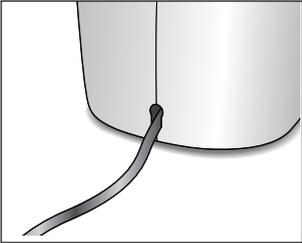
Stecken Sie den Netzstecker in die Steckdose. Die Maschine ist mit einem Kabelfach ausgestattet. Ziehen Sie die Anschlussleitung soweit wie nötig aus dem Fach heraus bzw. schieben Sie die nicht benötigte Länge ins Fach zurück. Drücken Sie die Leitung an der Austrittsöffnung nach unten, um sie zu fixieren.
