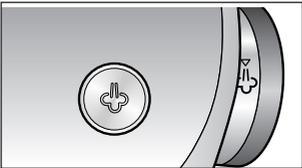
Drücken Sie die Taste mit dem Dampf-Symbol
