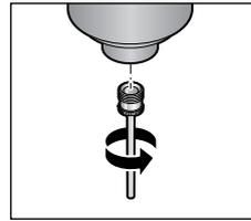
1. Um etwas Luft abzulassen, schrauben Sie die Nadeldüse von der Luftpumpe und feuchten sie mit etwas Seifenwasser an.
