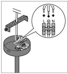
► Lassen Sie die Stromleitung von einer Fachkraft mit der Lüster-klemme verbinden.
