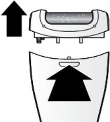
Um einen Aufsatz zu entfernen, drücken Sie die Arretierungstaste und ziehen Sie den Aufsatz nach oben ab.
