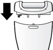
Um den anderen Aufsatz zu montieren, stecken Sie ihn wie abgebildet auf das Gerät und drücken ihn fest, bis er hör- und spürbar einrastet.
