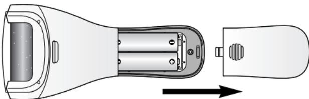
1. Öffnen Sie das Batteriefach auf der Geräteunterseite, indem Sie leicht auf die geriffelte Fläche drücken und den Deckel in Pfeilrichtung abschieben.
