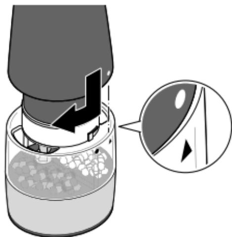
1. Setzen Sie das Gehäuse wieder auf den Mahlbehälter. Der Punkt auf dem Gehäuse zeigt dabei auf das Dreieck am Mahlbehälter.
