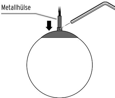
▷ Drehen Sie die Madenschraube oben am Teller etwas heraus, so dass Sie den Teller ganz nach unten über die Metallhülse bis zum Blech schieben können.
