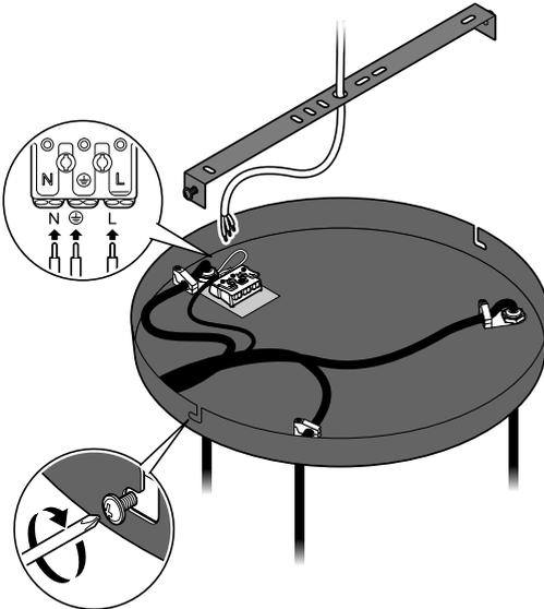
1. Lassen Sie die Stromleitung von einer Fachkraft mit der Lüsterklemme verbinden.
