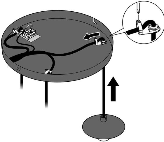
Bei Anlieferung sind die Anschlusskabel mit größtmöglicher Länge befestigt. Sie können jedes der Anschlusskabel individuell kürzen.
