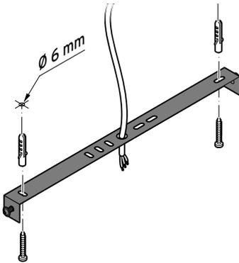
3. Befestigen Sie den Deckenbügel mit den Dübeln und Schrauben an der Decke.
