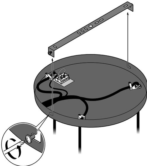
3. Lösen Sie die beiden seitlichen Befestigungsschrauben, mit denen der Deckenbügel am Leuchenträger befestigt ist, so weit, dass Sie den Deckenbügel abnehmen können.
