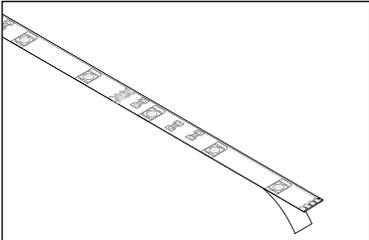
Ziehen Sie die Schutzfolie vom Selbstklebestreifen. Befestigen Sie die Lichtleiste sorgfältig auf dem ausgewählten Untergrund, indem Sie sie andrücken. Platzieren und befestigen Sie die Halterungen entsprechend.
