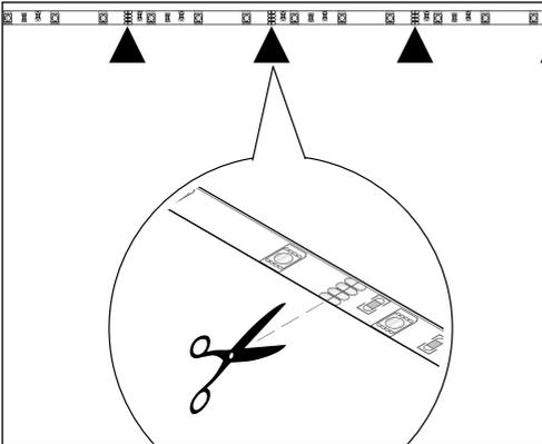
Kürzen Sie die Lichtleiste bei Bedarf mit einer scharfen Schere an einer der dafür vorgesehenen, kupferfarbenen Stellen (insgesamt acht).
