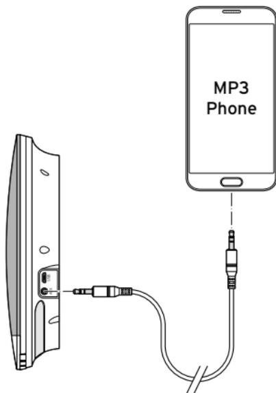
1. Verbinden Sie den Kopfhörer-Ausgang des Wiedergabegerätes über das beiliegende Audiokabel mit der Anschlussbuchse **AUX** am Lautsprecher.
