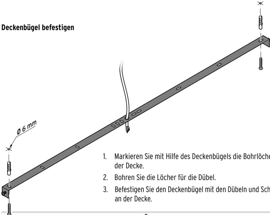
1. Markieren Sie mit Hilfe des Deckenbügels die Bohrlöcher an der Decke.
