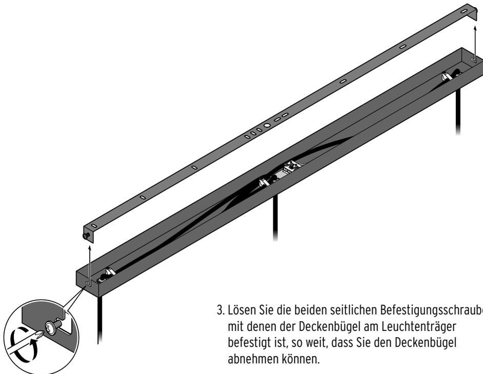
3. Lösen Sie die beiden seitlichen Befestigungsschrauben, mit denen der Deckenbügel am Leuchtenträger befestigt ist, so weit, dass Sie den Deckenbügel abnehmen können.
