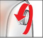
Drehen Sie den Drehknopf langsam gegen den Uhrzeigersinn über den Widerstand hinaus. Eine geringe Menge Wasser tritt aus.
