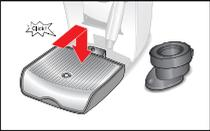
Schieben Sie die Abtropfschale bis zum Anschlag ein, bis sie einrastet. Prüfen Sie den festen Sitz.
