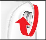
Das Dampfventil muss geschlossen sein. Drehen Sie ggf. den Drehknopf bis zum Anschlag im Uhrzeigersinn.
