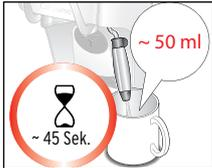
Wasser wird in das Leitungssystem gepumpt.
