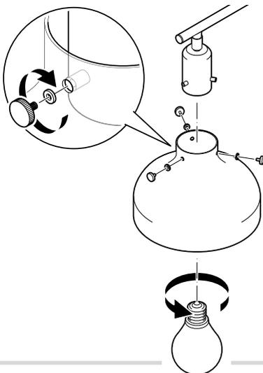
1. Befestigen Sie den Lampenschirm wie abgebildet mit den Scheiben und den Rändelschrauben am Leuchtenkopf.
