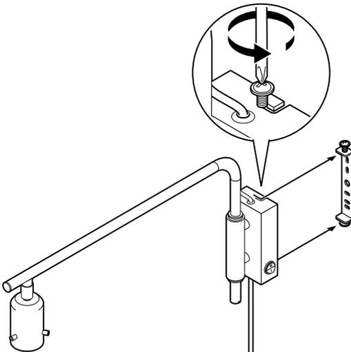
1. Lösen Sie die beiden Befestigungsschrauben oben und unten am Leuchtenträger, mit denen der Wandmontagebügel an der Leuchte befestigt ist, so weit, dass Sie den Wandmontagebügel abnehmen können.
