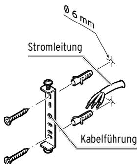
2. Führen Sie die Stromleitungen durch die Kabelführung des Wandmontagebügels. Befestigen Sie den Wandmontagebügel mit den Dübeln und Schrauben an der Wand.
