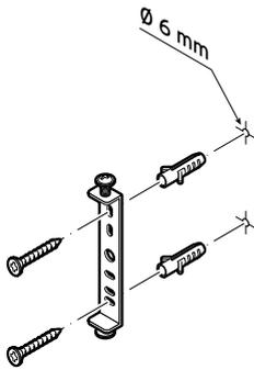
2. Markieren Sie mit Hilfe des Wandmontagebügels die Bohrlöcher.
