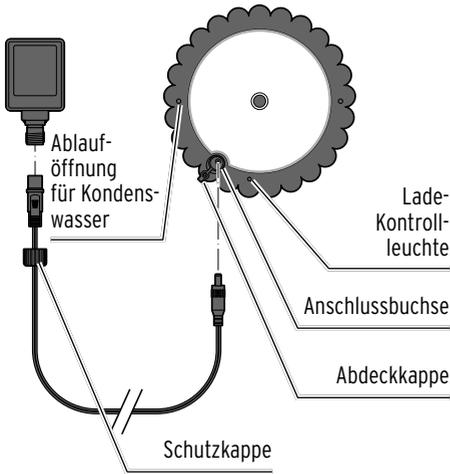
2. Stecken Sie das eine Ende des Anschlusskabels in die Anschlussbuchse auf der Unterseite des Lampenschirms und das andere Ende in die Anschlussbuchse am Netzadapter. Drehen Sie die Schutzkappe fest.
