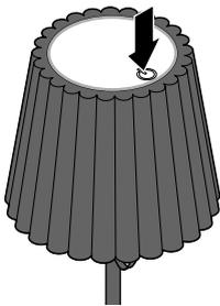
▷ Um die **LEDs dauerhaft einzuschalten**, drücken Sie den Ein-/Aus-Schalter **1x kurz**.
