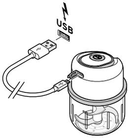
1. Öffnen Sie die Abdeckkappe der USB-Ladebuchse am Motorblock.
