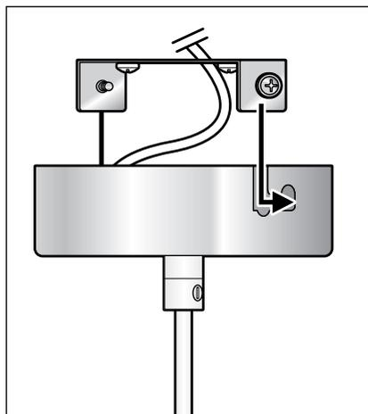
2. Schieben Sie den Leuchenträger auf die beiden leicht eingedrehten Befestigungsschrauben des Deckenbügels auf.
