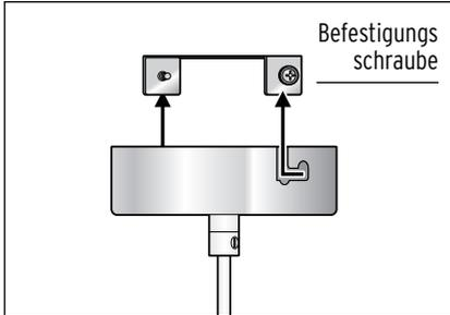
2. Lösen Sie die beiden seitlichen Befestigungsschrauben, mit denen der Deckenbügel am Leuchten-träger befestigt ist, so weit, dass Sie den Deckenbügel abnehmen können.
