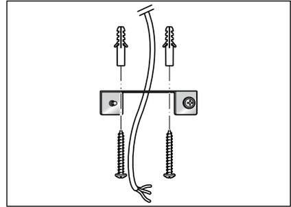
5. Befestigen Sie den Deckenbügel mit den Dübeln und Schrauben an der Decke.
