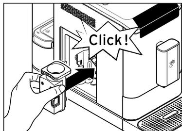
7. Drücken Sie die Brüheinheit mit etwas Kraft wieder gerade in die Maschine hinein, ohne die orangefarbenen Tasten zu drücken. Die Brüheinheit muss hörbar und spürbar einrasten.
