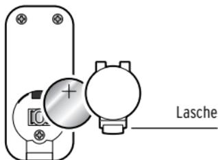
1. Drücken Sie die kleine Lasche am Batteriefachdeckel nach oben. Heben Sie den Batteriefachdeckel nach oben ab.
